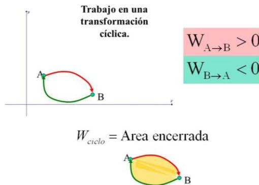
Si el ciclo se recorre en el sentido de las agujas del reloj, el calor es positivo, es decir, absorbido por el sistema; y si se recorre en sentido antihorario, el calor es negativo.
